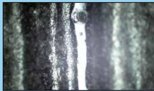
Fotografia mikroskopowa pokazująca wizualny efekt stosowania standardowej technologii z widocznym „zamleczeniem” oraz bąbką powietrza
