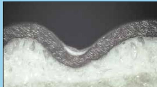
Fotografia mikroskopowa pokazująca przekrój wyrobu gotowego wykorzystującego standardowy proces z widocznym nadmiarem lakieru w zagębieniu struktury kalandra
