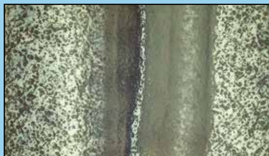
Fotografia mikroskopowa pokazująca prawidłowo zabezpieczony wyrób bez widocznych defektów
