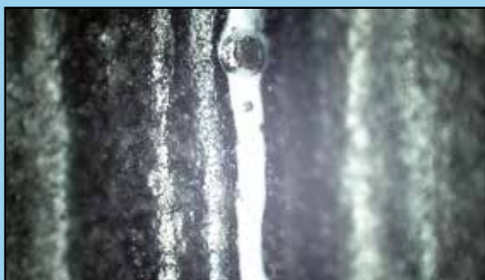
Fotografia mikroskopowa pokazująca wizualny efekt stosowania standardowej technologii z widocznym „zamleczeniem” oraz bańką powietrza
