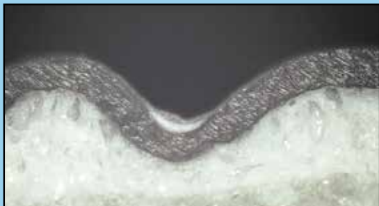
Fotografia mikroskopowa pokazująca przekrój wyrobu gotowego wykorzystującego standardowy proces z widocznym nadmiarem lakieru w zagłębieniu struktury kalandra
